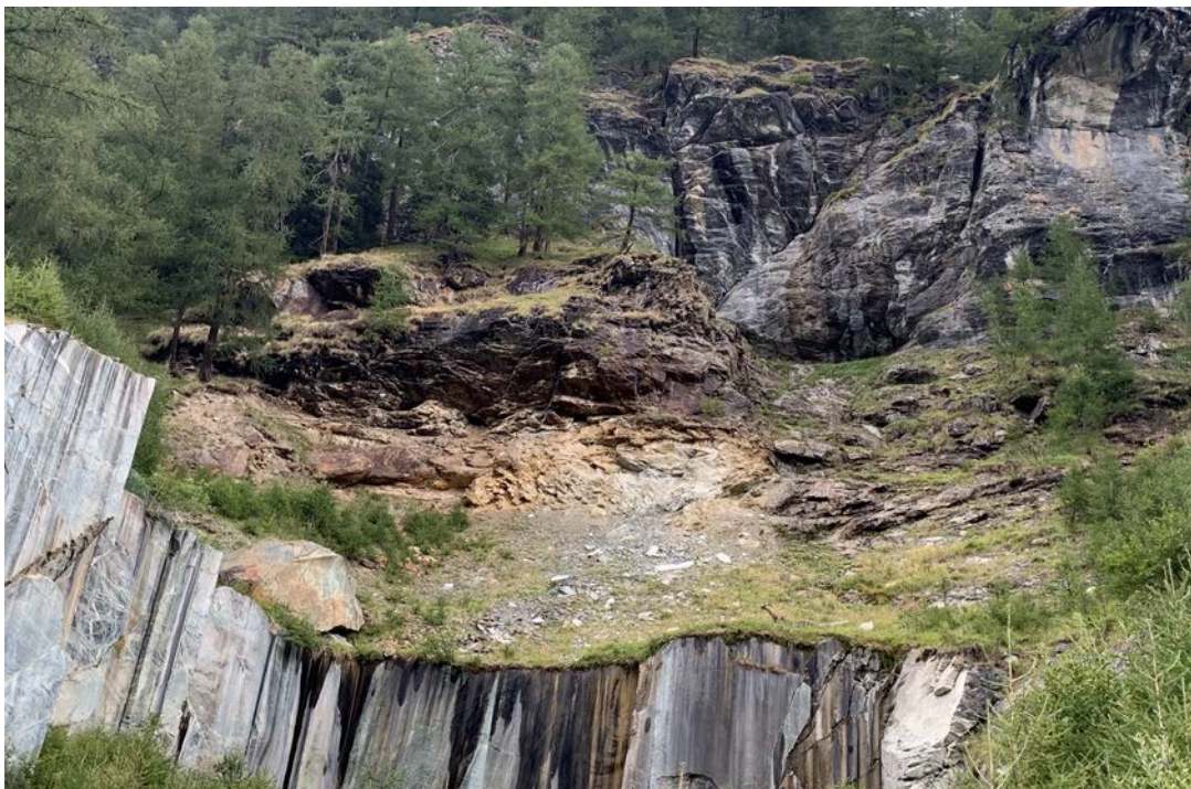
Accumulo detritico a monte del ciglio superiore sul confine EST dell'area di cava
